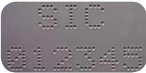
«Booster» card option : e10D p123 enables deep marking on hardened steels
